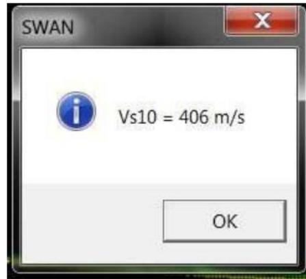
Poichè nel profilo il valore di velocità del substrato di riferimento (800 m/s) viene raggiunto alla profondità di circa 10 m, la velocità equivalente viene calcolata su tale spessore ottenendo il valore Vs10. Il parametro assume il valore di **406 m/s**.
