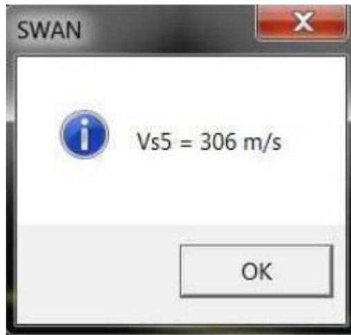
Poichè nel profilo il valore di velocità del substrato di riferimento (800 m/s) viene raggiunto alla profondità di circa 5 m, la velocità equivalente viene calcolata su tale spessore ottenendo il valore Vs5. Il parametro assume il valore di 306 m/s.
